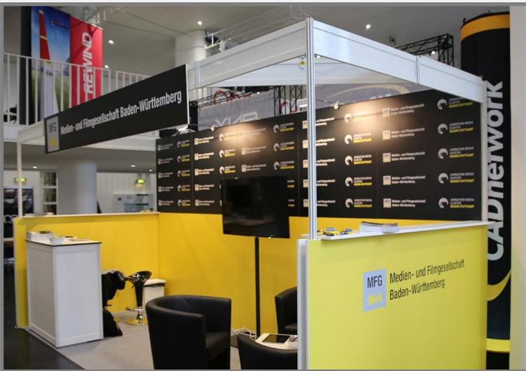
Einfache Decken werden an der Rückwand befestigt und an den offenen Standkanten aufgeständert. An dieser Deckenkonstruktion können Schilder befestigt werden, wie im Beispiel links zu sehen. Auch die Standbeleuchtung lässt sich gut anbringen.
