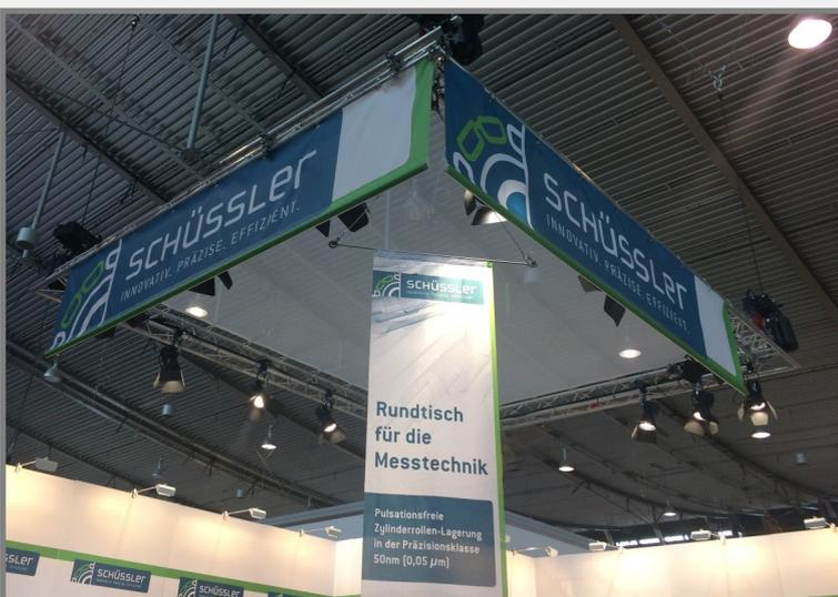
Abgehängte Decken, werden wie der Name bereits verrät, von der jeweiligen Hallendecke abgehängt. Hier im Bild gut zu erkennen sind, die Banner die ringsherum um das Traversensystem befestigt sind. Als symbolische waagrechte Decke wurde ein Mesh-Banner eingespannt um den Stand nach oben abzuschließen.
