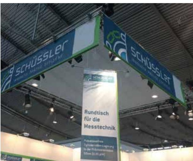
Abgehängte Decken werden, wie der Name bereits verrät, von der jeweiligen Hallendecke abgehängt. Hier im Bild gut zu erkennen, sind die Banner die rings um das Traversensystem befestigt sind. Als symbolisch waagrechte Decke wurde ein Mesh-Banner eingespannt um den Stand nach oben abzuschließen.
