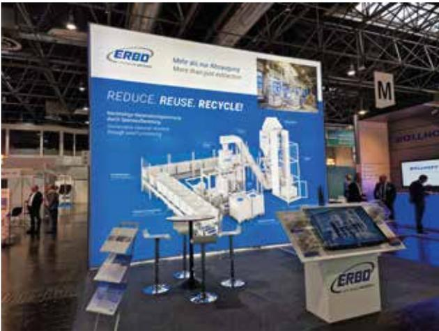
Eingespannte Banner zwischen den filigranen Aluminium-Rahmen verstecken das Systemmaterial fast vollständig und wirken durch das faltenfrei gespannte Material als ganze Wandfläche. Zudem können die Banner hinterleuchtet werden, um noch einen optischen Effekt zu erzielen.
