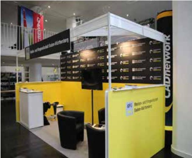
Einfache Decken werden an der Rückwand befestigt und an den offenen Standkanten aufgeständert. An dieser Deckenkonstruktion können Schilder befestigt werden, wie im Beispiel links zu sehen. Auch die Standbeleuchtung lässt sich gut anbringen.
